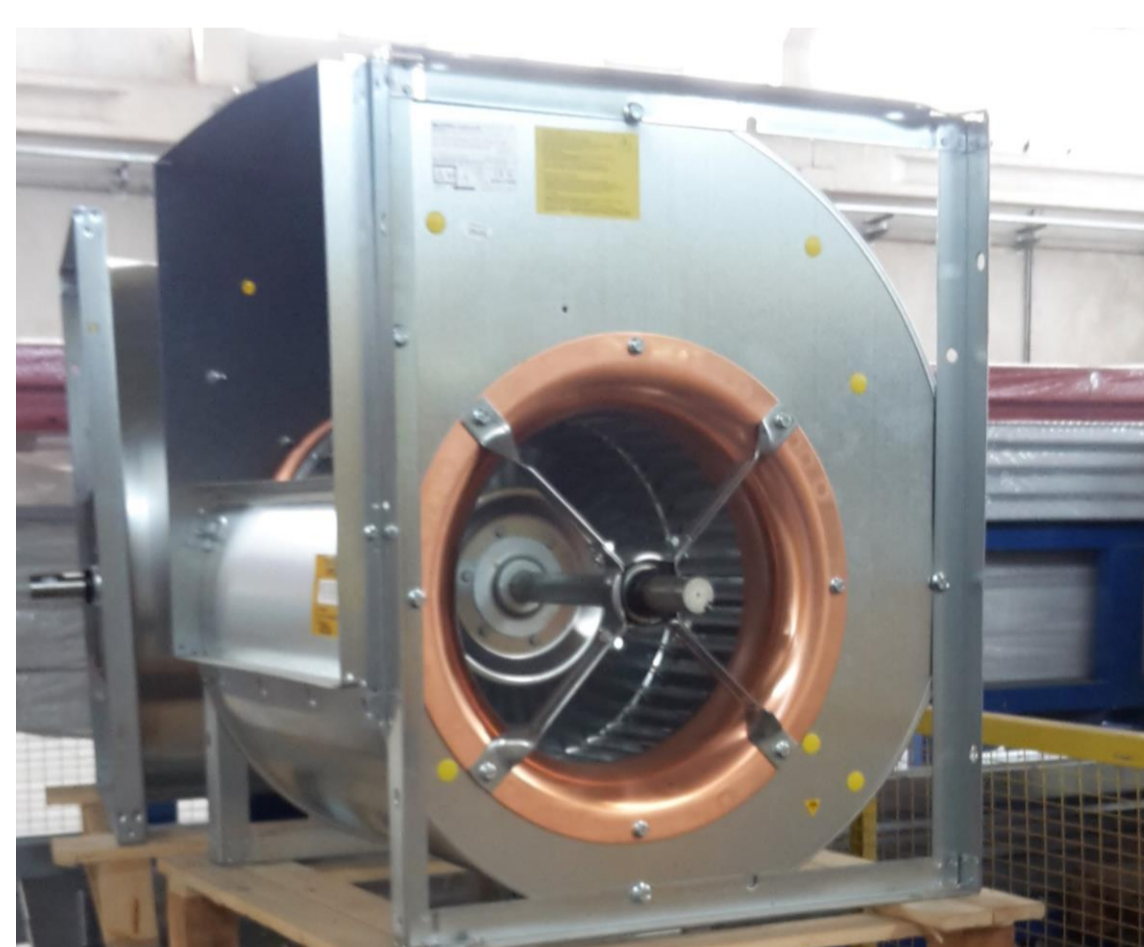
6 Ventilateurs à turbine à haut rendement Nicotra Gebardt
