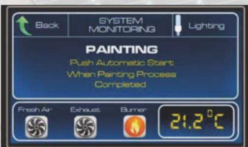
**5** | Panneau de contrôle tactile et intuitif, réglages des cycles personnalisables. Affichage de la température en temps réel.
