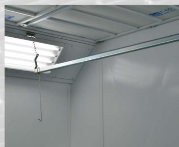
**7** | Barre de suspension coulissante pour la peinture et le séchage de pièces détachées
